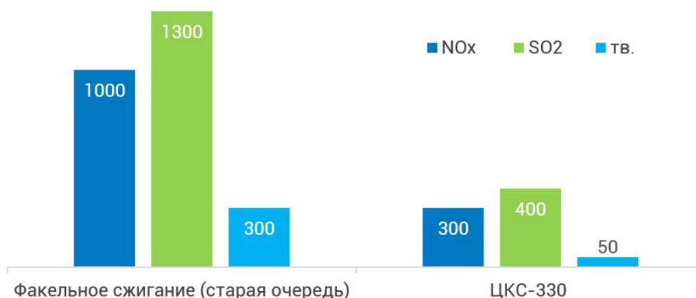
Уменьшение выбросов вредных веществ на ЦКС по сравнению с технологией традиционного сжигания угля, мг/м 3
