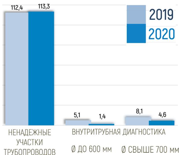
В 2020 году ПАО «МОЭК» провело комплексную техническую диагностику на 14 055 участках тепловых сетей общей протяженностью 2 348 км, в том числе методом внутритрубной диагностики. Выявлено 1 714 критических дефектов, по которым проведены работы по планово-предупредительному ремонту. В целях обеспечения надлежащего качества выполнения работ на объектах ремонта и реконструкции выполнен ультразвуковой контроль 8 330 сварных соединений.
